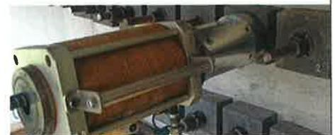
Hybridanker mit aufgesetzter Spannpressen.
